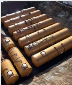
Fabrication dans notre usine (FR) de cuves simple et double paroi conformes aux normes européennes.
