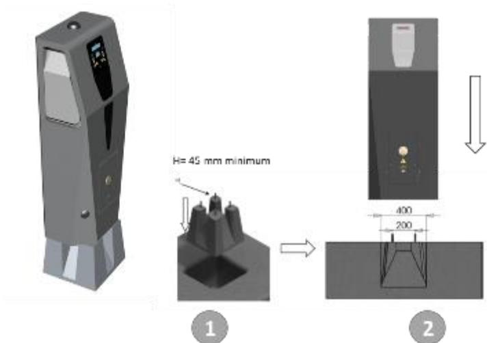
**ATTENTION** : quelle que soit la méthode de fixation de la borne, la gaine où passe le câble d'alimentation et la réserve pour fourreau doivent impérativement être bouchées.
