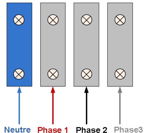
Figure 1. Raccordement de l'alimentation dans la borne
