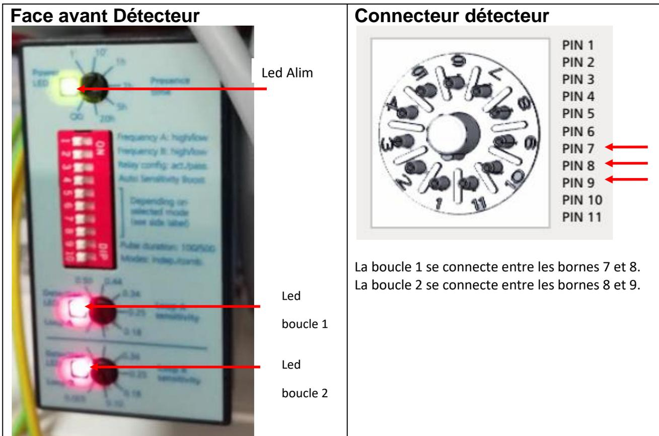
Les boucles au sol se connectent sur les 2 bornes **7 et 8** pour la boucle 1 et les bornes **8 et 9** pour la boucle 2. Le connecteur est accessible après avoir retiré le détecteur de son connecteur débrochable.
