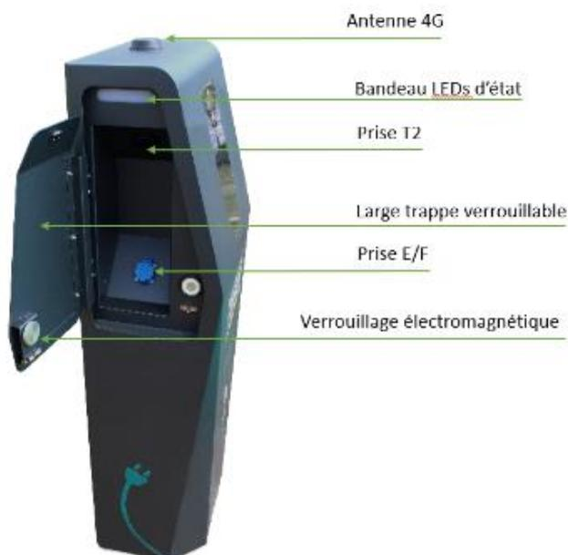
La borne de recharge VE PULSE 22 est équipée de 1 à 4 prises et permet 2 charges simultanées. Chaque point de charge permet la recharge d'un véhicule électrique en mode 1, 2 sur prise de type domestique ou 3 sur une prise Type 2S (Normalisé véhicules électriques).
