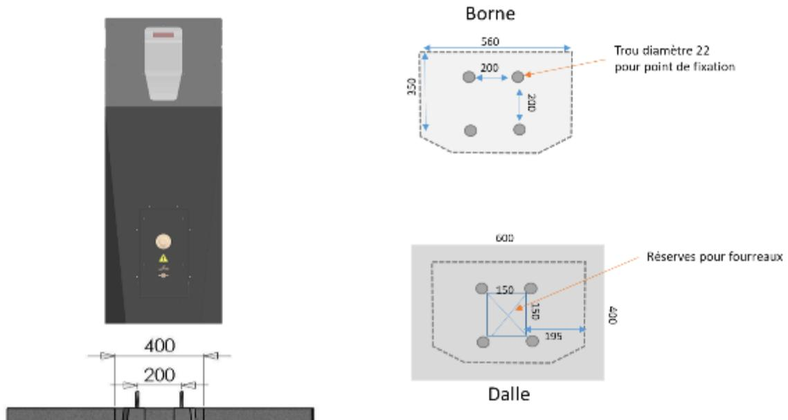
1. Positionner la borne, repérer les points de fixation et sceller des tiges filetées. Celles-ci devront dépasser du sol de 45mm minimum. Vous pouvez également utiliser le scellement chimique. Dans le cas d'utilisation de massifs de candélabres préfabriqués, il n'est pas nécessaire de recouper les goujons M18.
