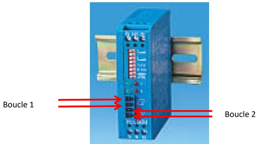
La « boucle 1 » correspond à la place de stationnement du point de charge 1. Elle se connecte en face avant du détecteur comme indiqué ci-dessus. Idem pour la « boucle 2 ».
